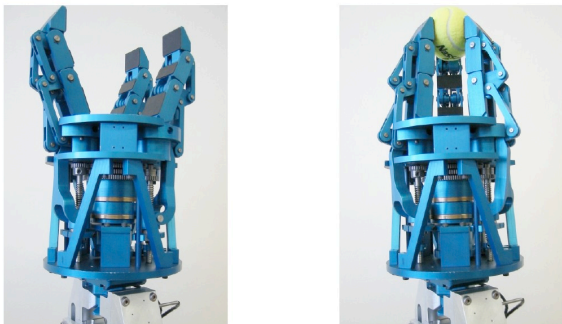
Figure 1 : Exemple d'une main articulée à 12 ddl rapport S. Chevalley, « Organes de préhension » 2004
